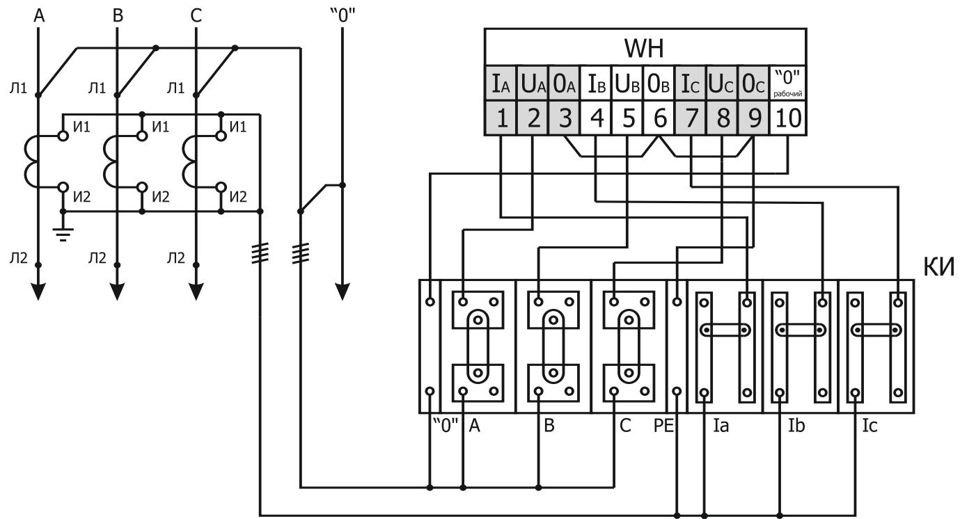
**ДЕСЯТИПРОВОДНАЯ СХЕМА ПОДКЛЮЧЕНИЯ
